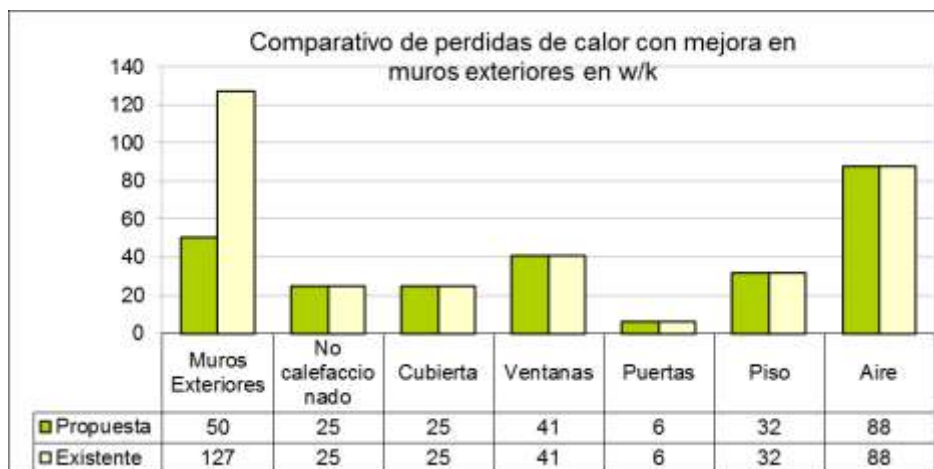
Gráfico 10: comparativo de muros existentes y mejorados con membrana. Norma Iram 11604
