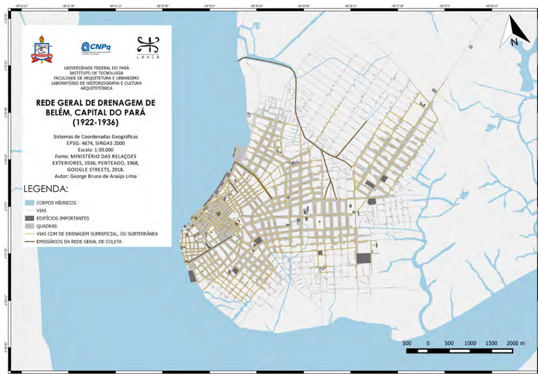
Figura 4. Mapa temático que representa o sistema coletivo de coleta de esgoto, sem distinção entre os sistemas de micro drenagem e as galerias de esgoto. Ministério das Relações Exteriores, 1936; Penteadó, 1968; Google Streets, 2018. Elaborado por George Bruno de Araújo Lima, 2018.
